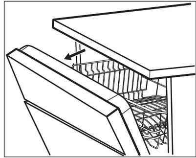
AirDry wird automatisch bei allen Programmen außer bei Vorspülen eingeschaltet.
