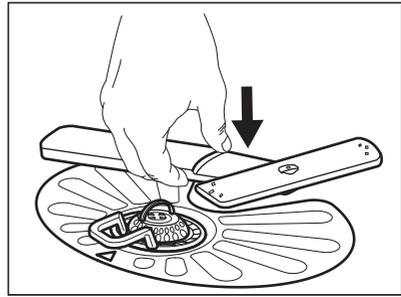
**10.6 Reinigen des oberer Sprüharms**
