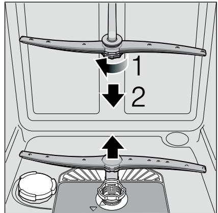
4. Sprüharme unter fließendem Wasser reinigen.
