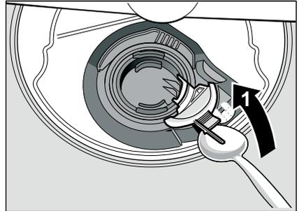
6. Flügelrad auf Fremdkörper prüfen und diese gegebenenfalls entfernen.
