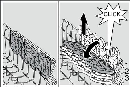
\* Je nach Modell ist eine 3-fache Höhenverstellung möglich. Dafür die Etagere zuerst senkrecht stellen und nach oben ziehen, dann, leicht schräg gestellt, nach unten auf die gewünschte Höhe (1, 2, oder 3) schieben und mit einem hörbaren Klick einrasten lassen.
