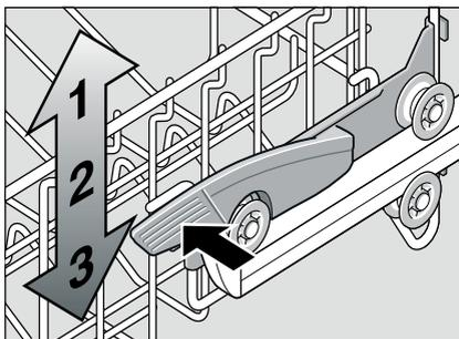
3. Zum **Anheben** fassen Sie den Korb seitlich am oberen Rand und heben ihn nach oben.
