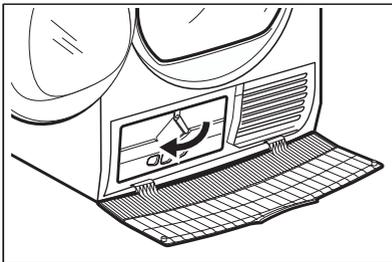
4. Klappen Sie den Kondensatordeckel nach unten.
