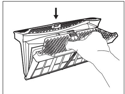
3. Reinigen Sie beide Teile des Siebs mit der feuchten Hand.
