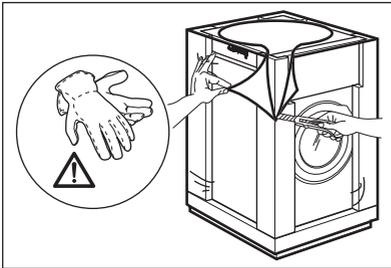
2. Entfernen Sie die Karton-Abdeckung und Styroporverpackungsteile.
