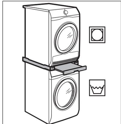
Der Wäschetrockner kann **nur mit dem von ELECTROLUX hergestellten und genehmigten Bausatz Wasch-Trocken-Säule auf der Waschmaschine montiert werden.**
