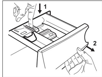
2. Entfernen Sie das Oberteil des Pflegemittelfachs, um die Reinigung zu vereinfachen, und spülen Sie es mit fließendem warmen Wasser aus, um das angesammelte Waschmittel zu beseitigen. Setzen Sie nach der Reinigung das Oberteil wieder ein.
