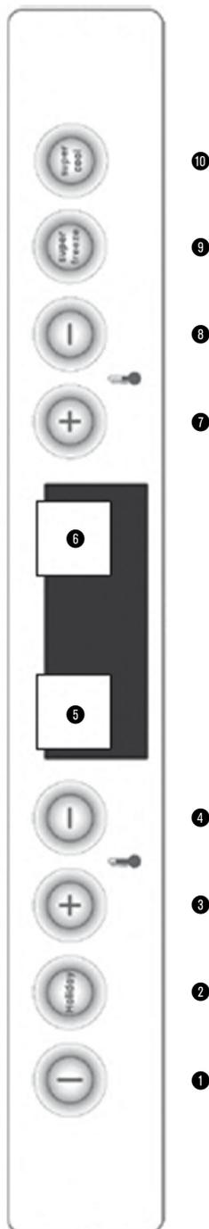
zia a lampeggiare e segna il valore selezionato. Ad ogni pressione del tasto corrisponde un aumento della temperatura di 1 °C. Tenendo premuto il tasto, il valore sale automaticamente fino a raggiungere il valore massimo oppure finché si rilascia il dito. Circa 5 secondi dopo il rilascio, il display smette di lampeggiare e viene di nuovo indicato il valore medio attuale della temperatura.
