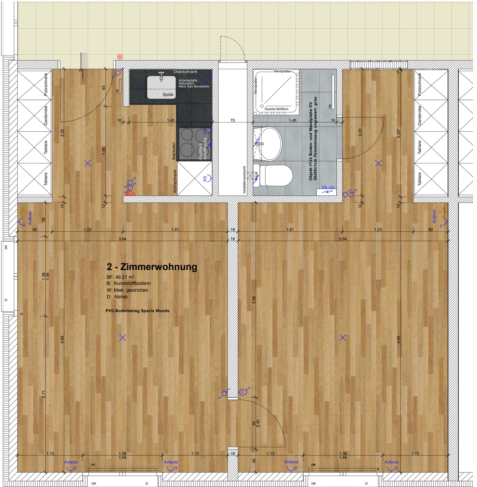
Sämtliche Masse sind am Bau zu kontrollieren. Unklarheiten sind vor Ausführung der Bauleitung mitzuteilen. Für Mängel, die aus nicht beachten dieser Regel entstehen, haftet der Unternehmer. Alle Masse sind, wenn nicht anders gekennzeichnet, Rohmasse. Bei Fensteröffnungen sind die Koten zu berücksichtigen. Türhöhen verstehen sich ab ok Schwelle oder höherem, fertigem Boden bis uk roher Sturz.
